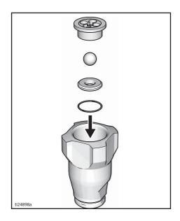
10. Torque to  $100 \pm 5$  ft-lb  $(136 \pm 7 \text{ N} \cdot \text{m})$ .
